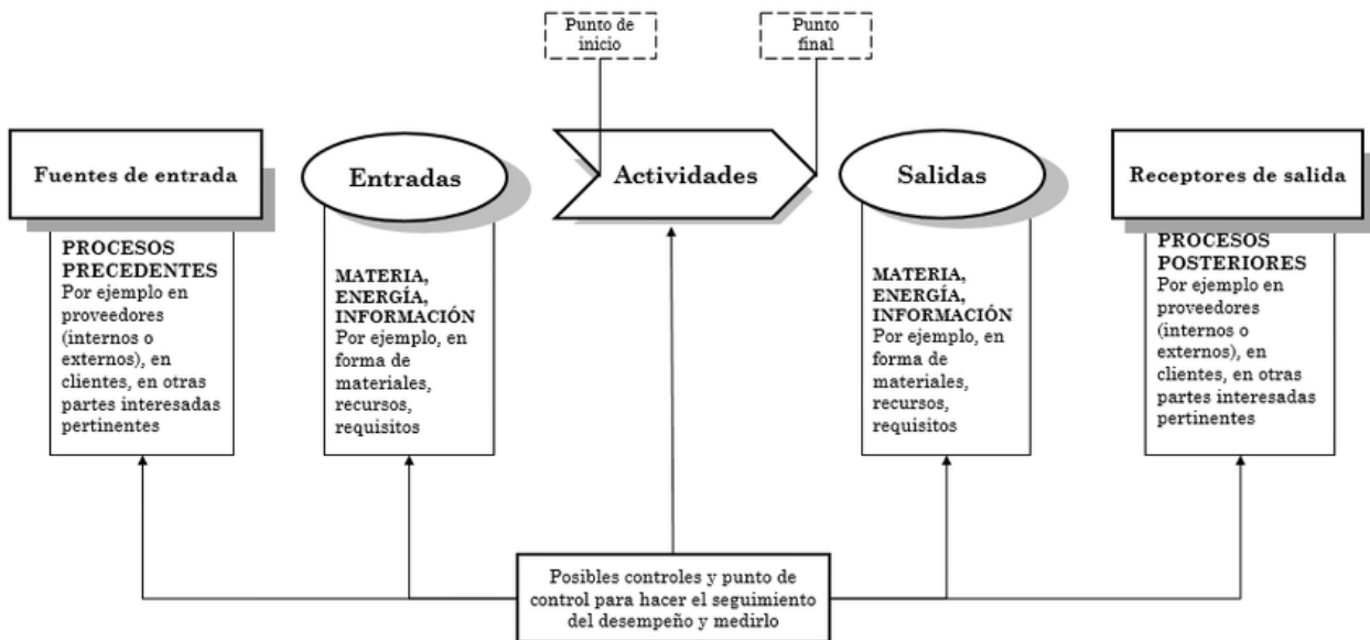
Figura 2. Esquema de representación de los elementos de un proceso. Fuente: Norma ISO9001:2015
