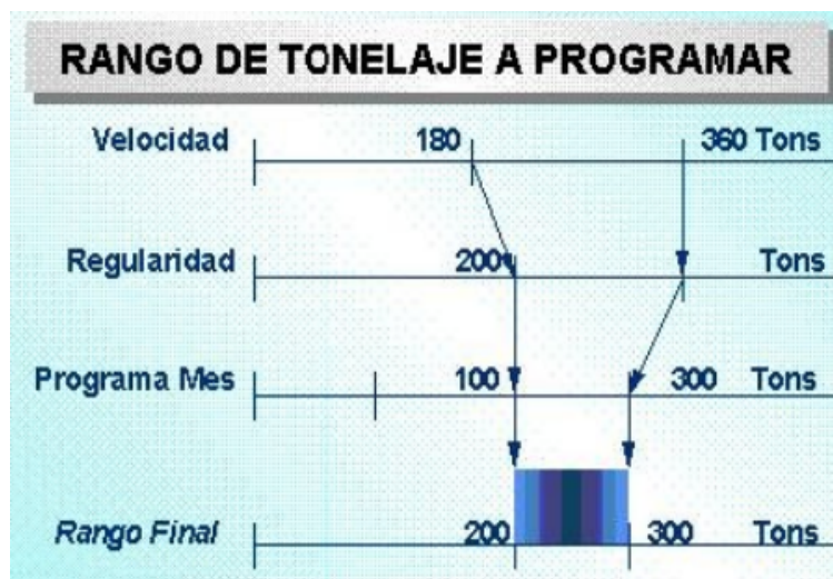
Figura 2.5: Ejemplo de límites de material a extraer por punto de extracción [3].
