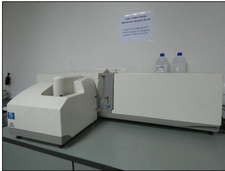
Figura 4.9 Granulómetro Malvern Mastersizer 2000. Laboratorio de Sedimentología, Departamento de Geología, Universidad de Chile.
