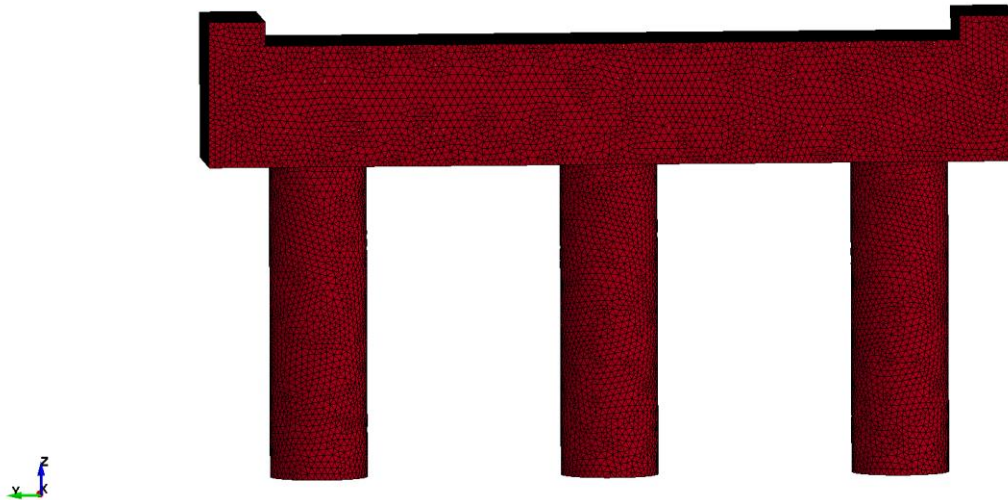
Figura 6.20: Vista de Hormigón en Modelo Cepa Completo de Puente Águila Norte.
