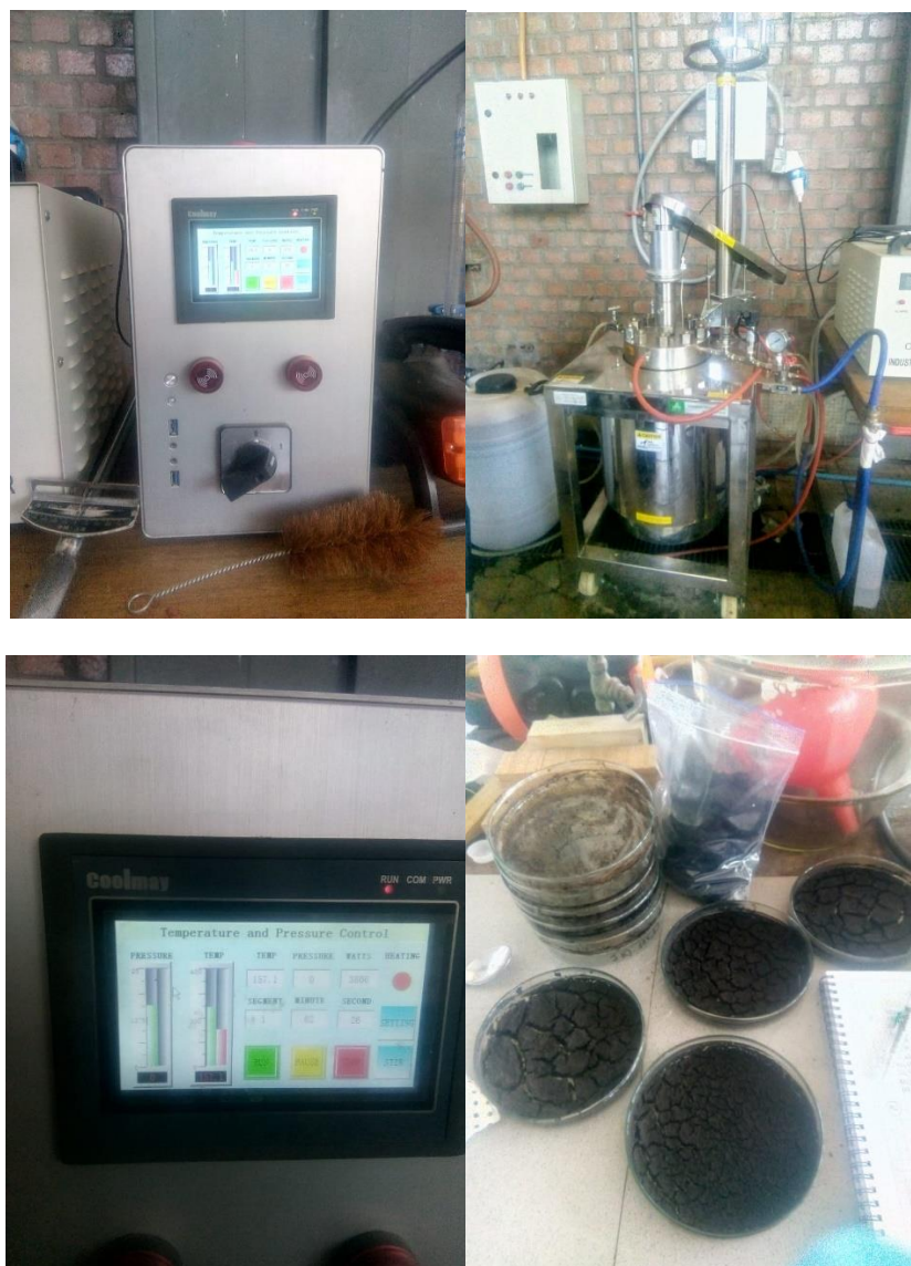
Figura 8. Equipo utilizado en carbonización hidrotermal
