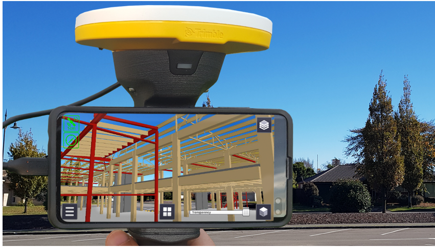
Figura 4.8: Trimble SiteVision, imagen referencial. Fuente: Trimble Field Technology.
