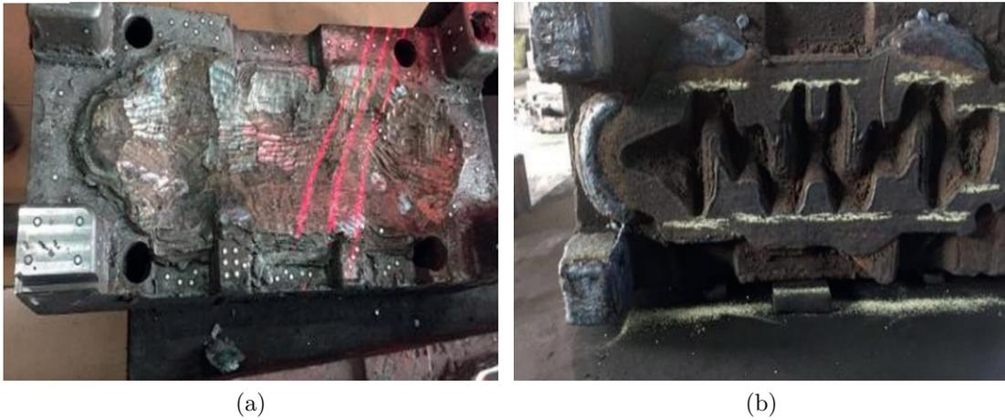
Figura 2.23: a) Después de eliminar las grietas; (b) Después de WAAM automático [37].
