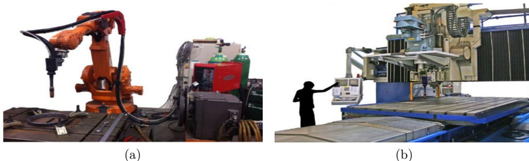
Figura 2.6: Opciones de sistemas de movimiento para WAAM: (a) Robot de soldadura ABB de seis ejes y (b) Sistema de deposición adaptado a la antigua máquina de soldadura por fricción y agitación [12].
