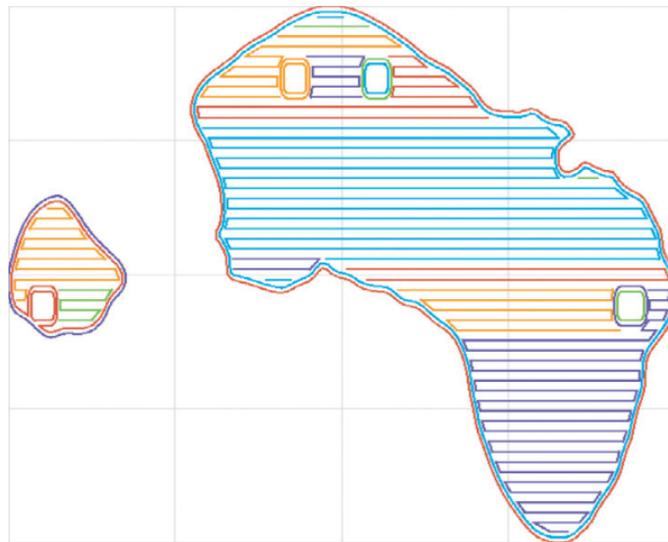
Figura 2.22: Trayectoria de llenado de una capa en una matriz de forjado caliente [37].
