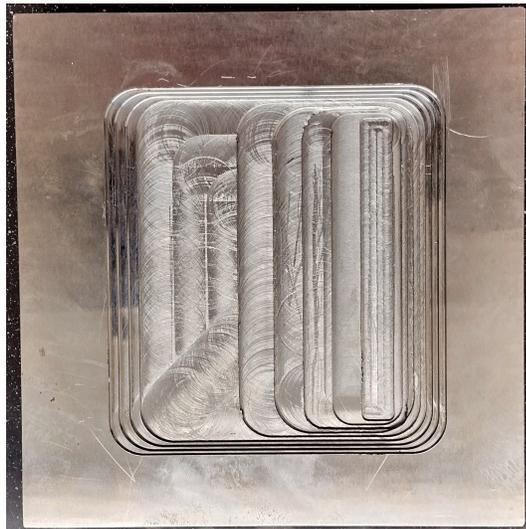
Figura 4.35: Placa de acero al carbono con daño tipo abrasión.
