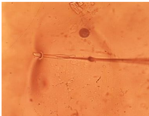
Figura 2: Voltage-Clamp con aislación por grasa de silicona. Se observa la configuración final del experimento, donde el capilar de boro-silicato atraviesa tanto la fina capa de silicona como la membrana de la fibra muscular estudiada, la que presenta su extremo libre sin cobertura de silicona. Imagen propia.
