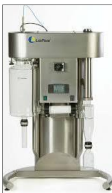
FIGURA 15. Secador por aspersión SD-06AG Laboratory Spray Dyer, Labplant, UK.
