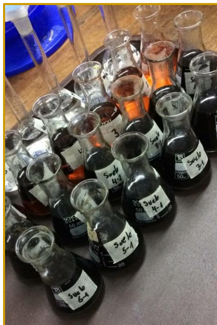
Figura 8: Determinación de carbono orgánico.
