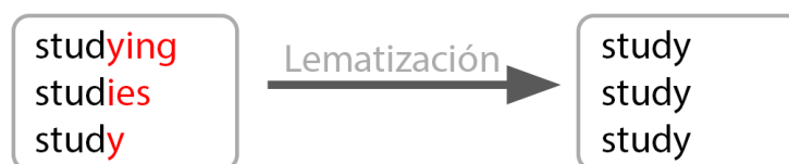
Figura 3.3: Ejemplo del proceso de lematización. Al lado izquierdo se tiene un conjunto de palabras flexionadas, las cuales al ser procesadas con un algoritmo de lematización se obtiene la palabra base a la derecha.
