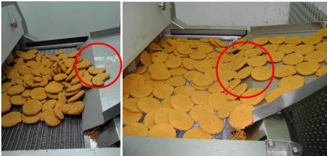
**Figura 16.** Cambio del diseño de placa de deslizamiento a la salida de freidora (acción: A-9).
