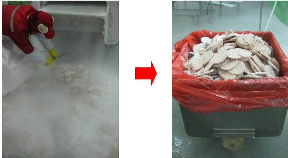
**Figura 19.** Consecuencias de un mal armado de línea a la salida de túnel de congelación.
