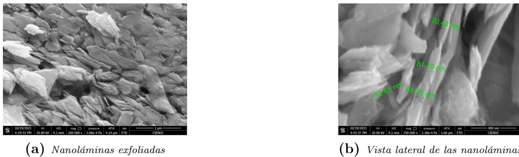
Figura 3.6: Imágenes SEM para nanopartículas exfoliadas de MoS_2 . Se presenta (a) la morfología de las nanoláminas en un nivel de magnificación de 100.000\times ; así como (b) el grosor aproximado de las capas observadas desde una vista lateral, con una magnificación de 250.000\times
