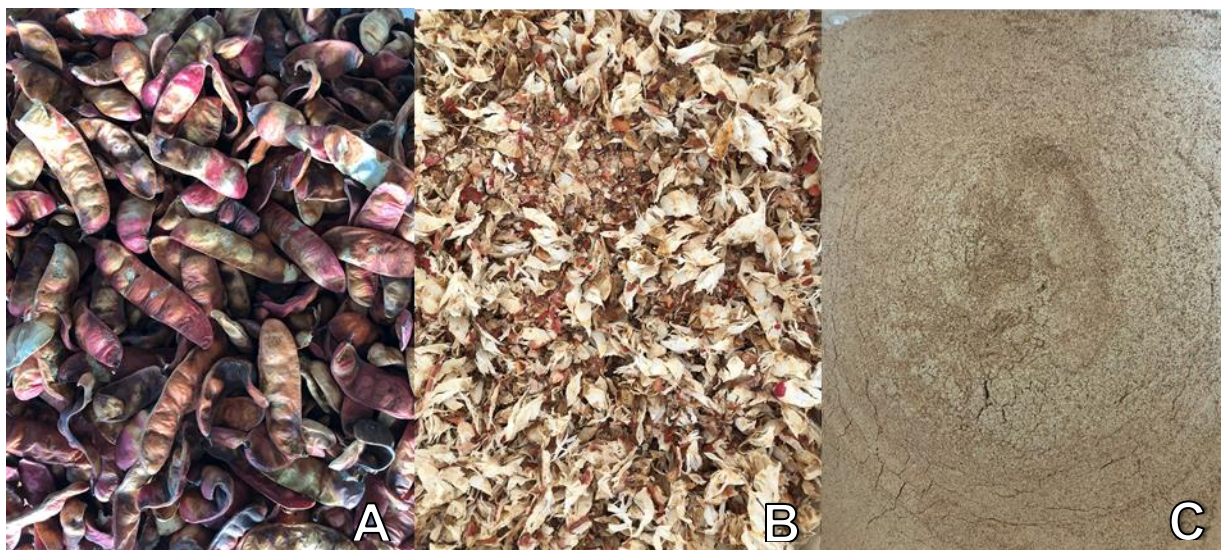
Figura 4. Estado de las vainas de tara en proceso de trituración: (A) Fruto de la tara completa, (B) Vainas de tara trituradas manualmente + cutter y (C) Polvo de vainas de tara triturado en molino de cuchillas.
