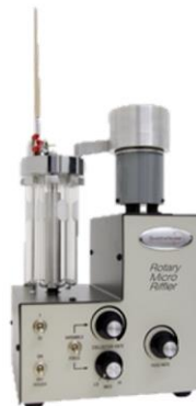
Figura 27. Cortador de muestras de laboratorio de 8 salidas.
