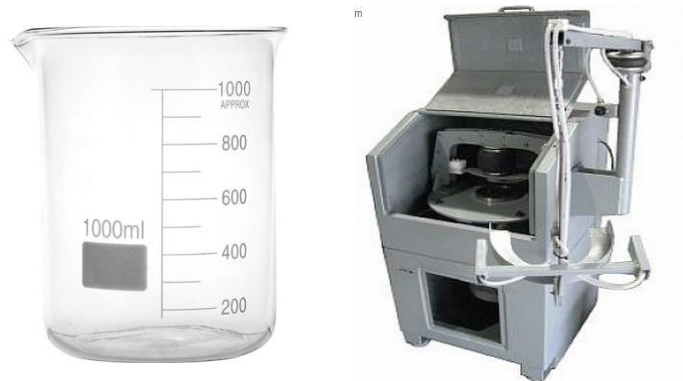
Figura 26. Vasos precipitados de 1000 mL (izquierda) y pulverizador de anillos (derecha).
