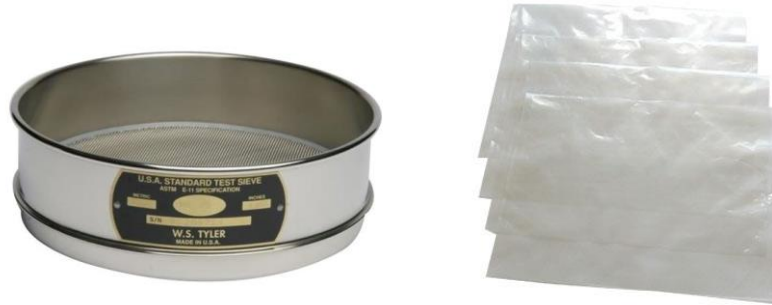
Figura 25. Tamiz de malla #200 Tyler (izquierda) y bolsas de muestreo (derecha).
