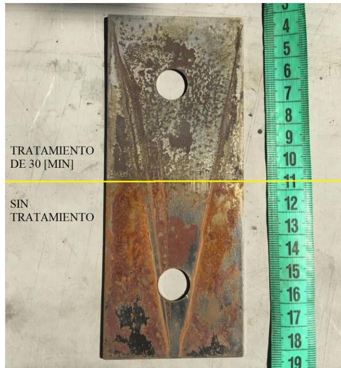
Figura 31. Placa de hierro oxidada tratada con ultrasonido por 30 [min] en uno de sus lados.
