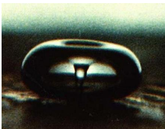
Figura 19. Burbuja de cavitación a punto de implosionar. [Suslick, 1989]
