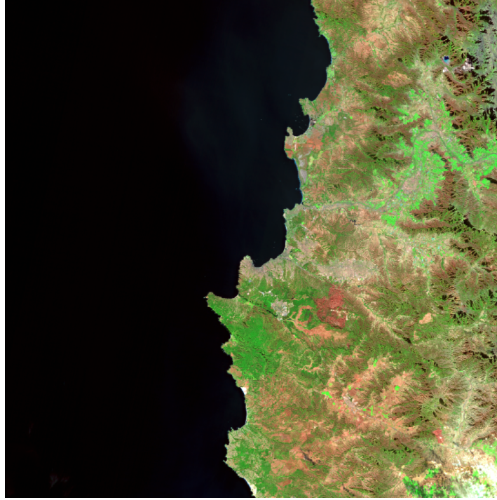
Figura 3.1: Imagen satelital de las bandas SWIR, NIR y Red, extraída de Sentinel-2A con 10 m de resolución
