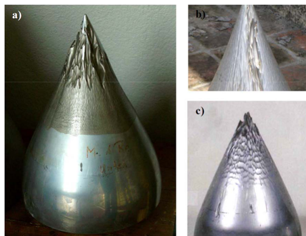
Figura 1.1: Puntas de tres agujas de turbina Pelton, mostrando el desgaste que se busca reparar. Imagen tomada de [2]
