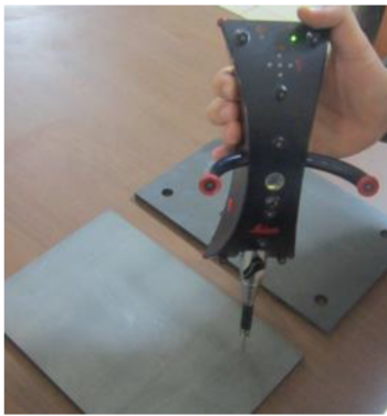
(a) Medición de la planitud de las placas.
