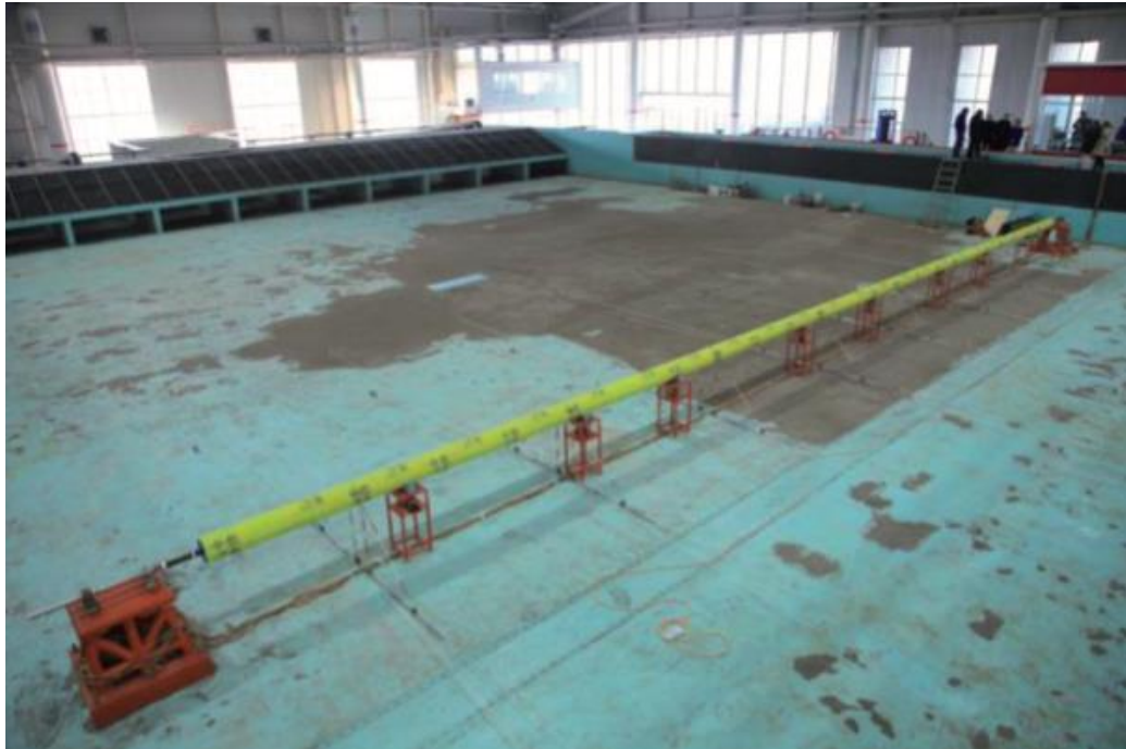
Figura 49: Foto de la prueba de comportamiento estructural general de túnel flotante. Fuente: Lin et al, 2019 [16].
