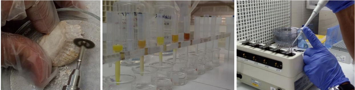
FIGURA 1.3. Algunas etapas en el proceso de datación de muestras en LUGIS. De izquierda a derecha: preparación mecánica, separación de Sr, carga y medición.
