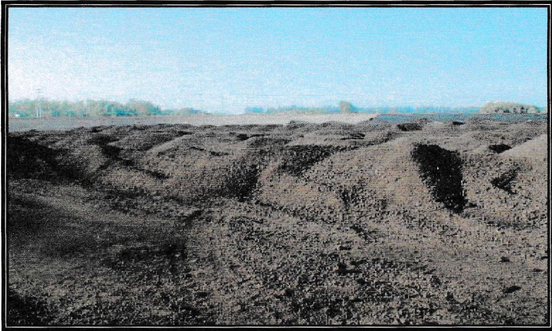
Figura 3 Secado al aire de lodos provenientes de la planta de tratamiento de aguas servidas “El Trebal” (Aguas Andinas S.A., 2003)
