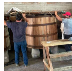
Ilustración 39: Montaje de rejilla en lagar. Fuente: Elaboración propia.
