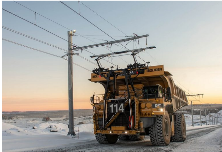
Figura 2.9: Camión Caex asistido por sistema trolley.
