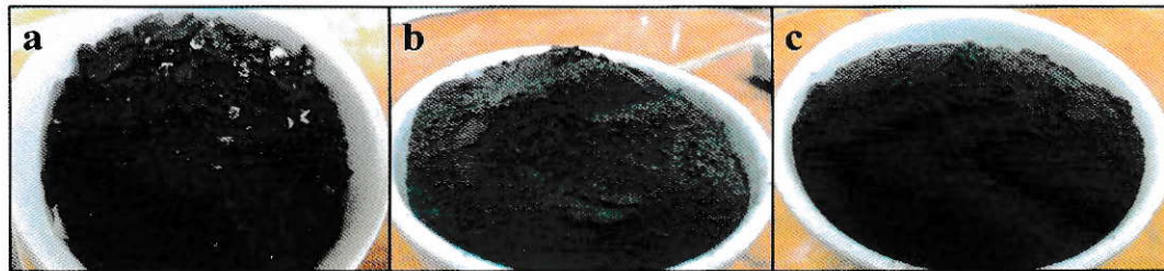
Figura 13. Compósitos obtenidos después del recubrimiento de zeolitas naturales con magnetita: (a) CP-SM, (b) CP-20 y (c) CP-120.
