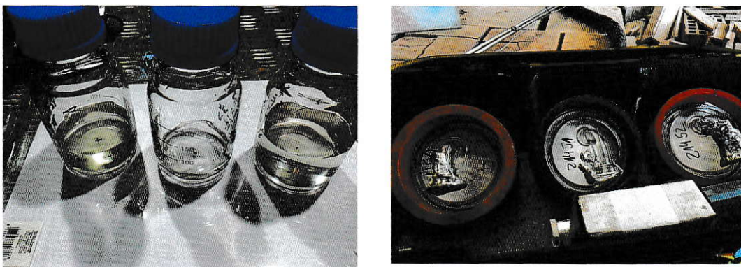
Figura 9 Muestras obtenidas del método CH-5 para material particulado en horno túnel
