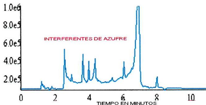
Figura 10. Cromatograma de pesticidas organoclorados que muestra la interferencia de azufre en muestras de biosólido.
