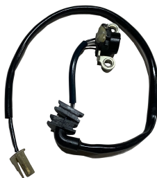
Figura 13: Sensor de posición del cigüeñal del motor Yamaha R6
