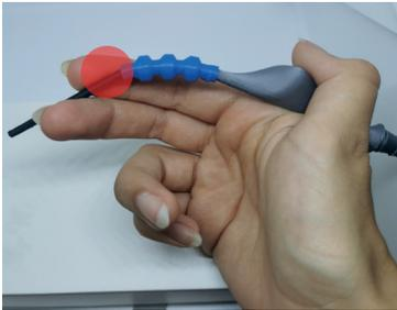
Flexión no se comporta de la manera deseada debido a la resistencia del material y espesor de la pieza retráctil y al ser presionada sin cuidado las piezas se desunen
