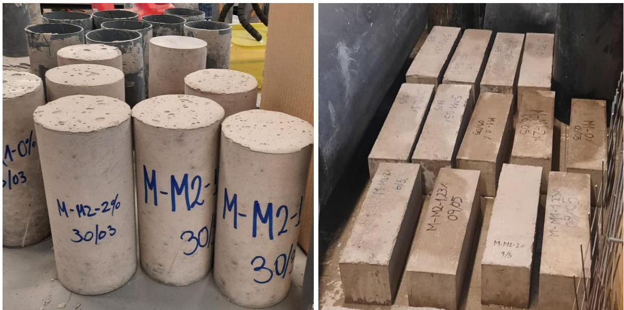
Figura 4.5: Probetas cilíndricas y prismáticas de hormigón reforzado con fibras de PVA.
