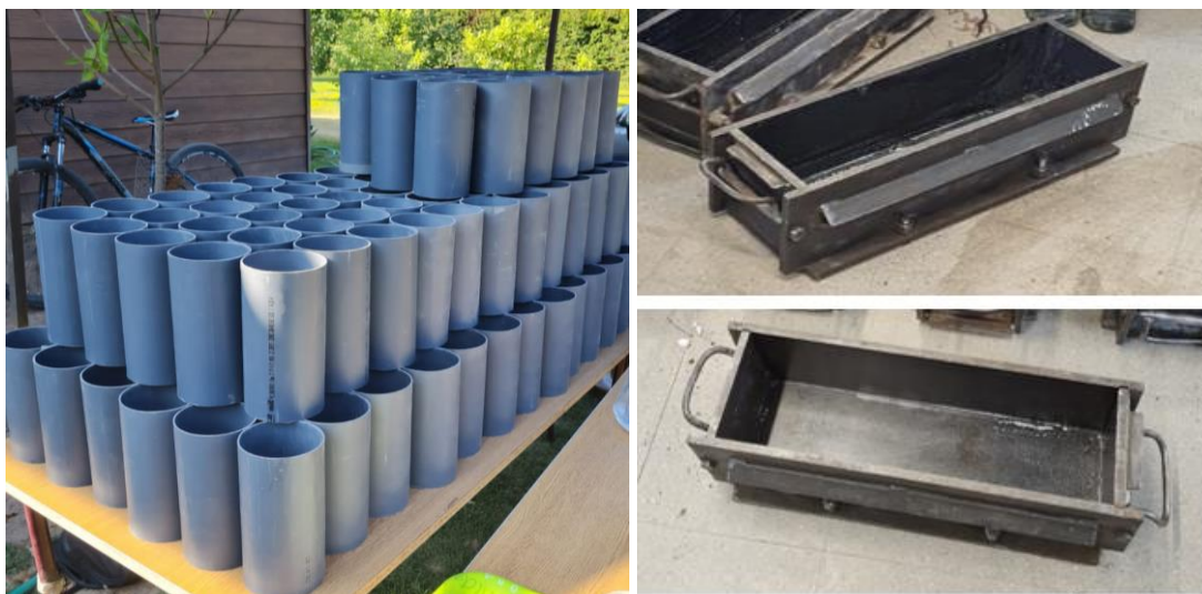
Figura 4.3: Moldaje cilíndrico y prismático.
