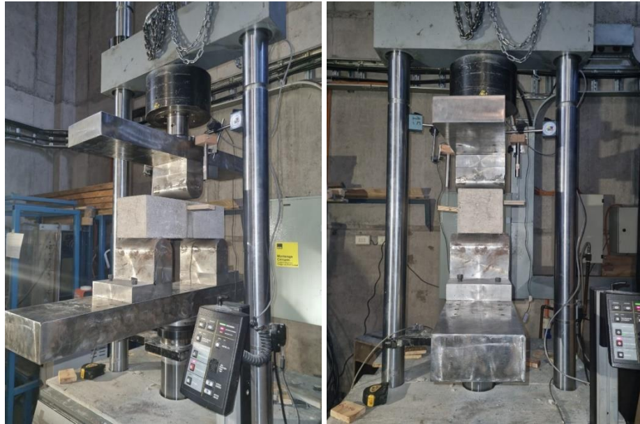
Figura 4.10: Montaje de viguetas a flexión.
