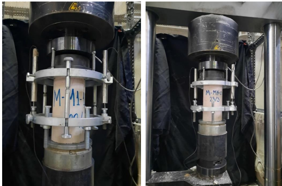
Figura 4.8: Montaje de cilindros a compresión.
