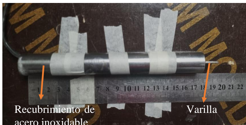
Figura B.1: Esquema de componentes internos del sensor LVDT.
