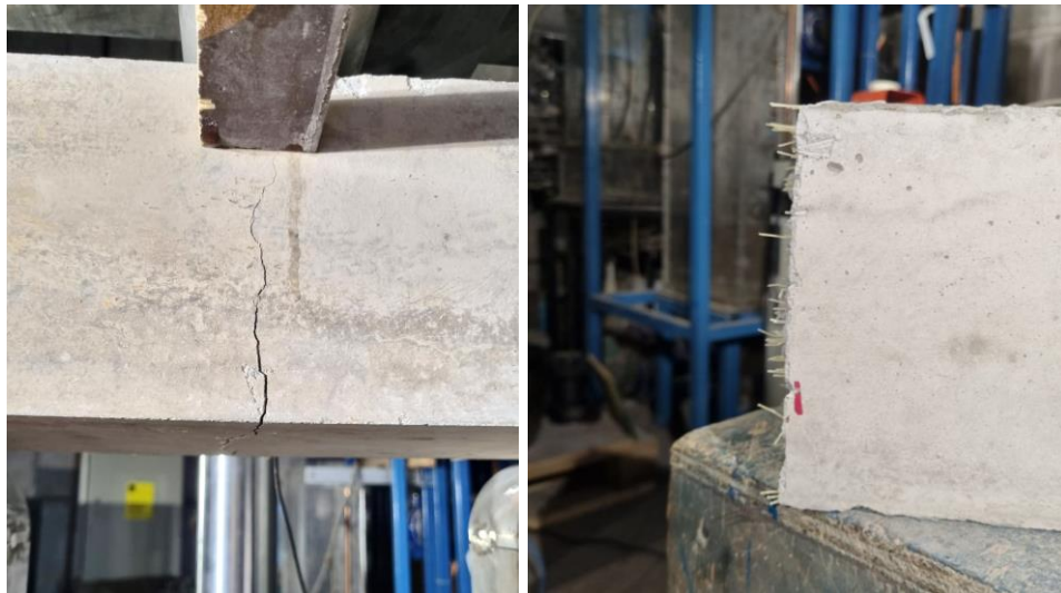
Figura 5.8: Modo de falla en probetas ensayadas a flexión.
