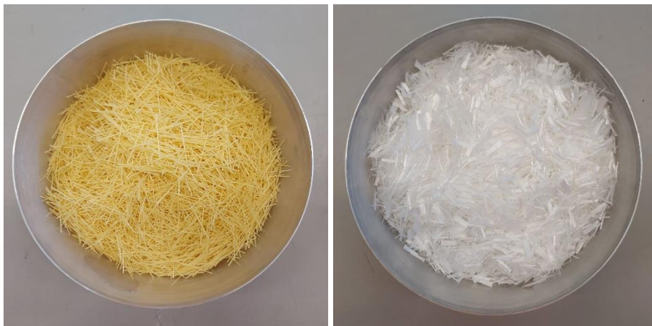
Figura 3.6: Fibra de PVA larga (a la izquierda) y corta (a la derecha).
