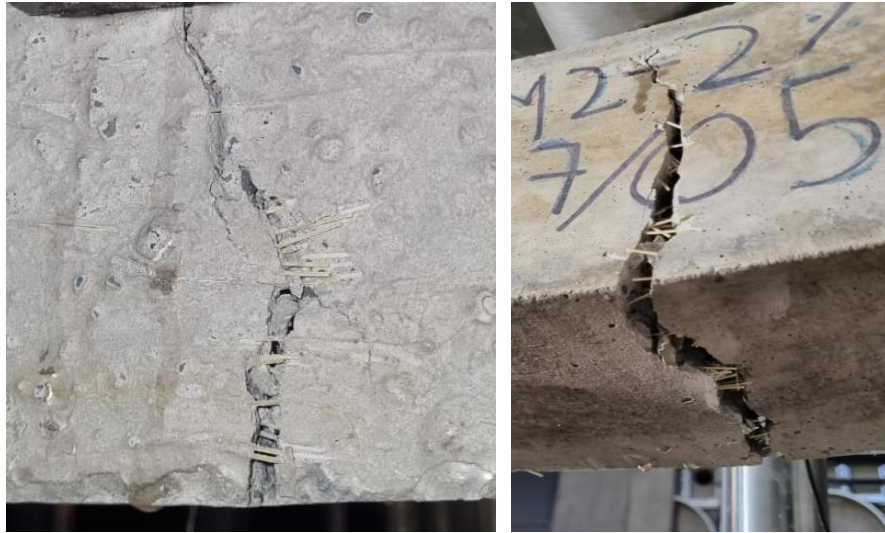
Figura 5.13: Efecto puente en probetas ensayadas a flexión.
