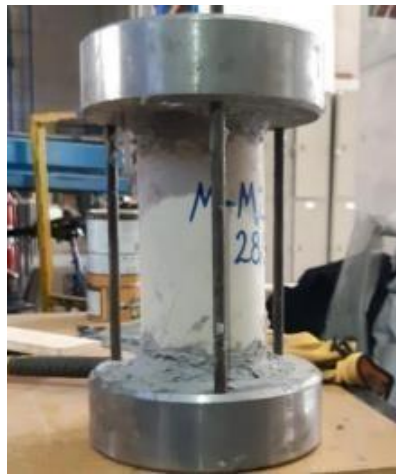
Figura 4-8 Pegado de la probeta en discos
