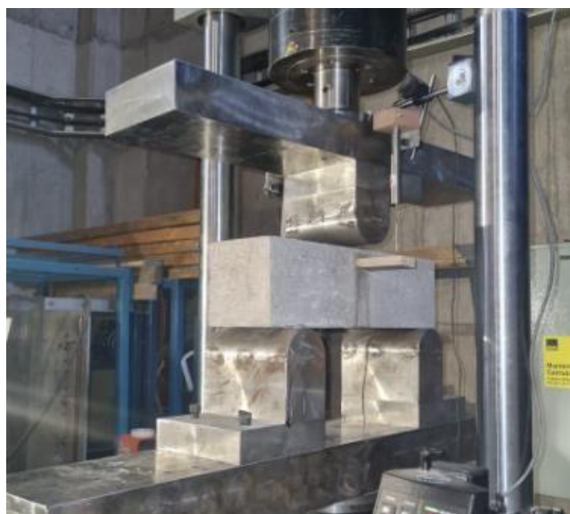
Figura 4-11 Montaje Ensayo Flexión
