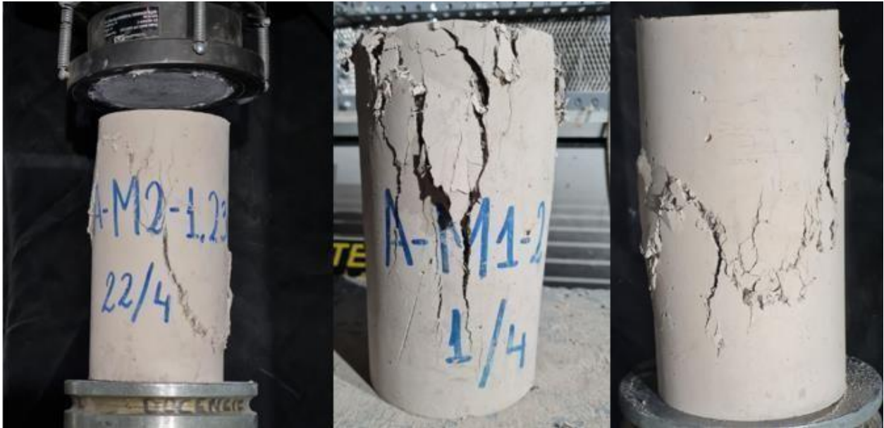
Figura 5-6 Modos de Falla Ensayo a Compresión
