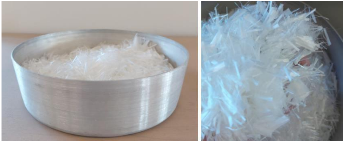
Figura 3-3 Fibra de Alcohol Polivinílico (PVA), largo 12[mm].
