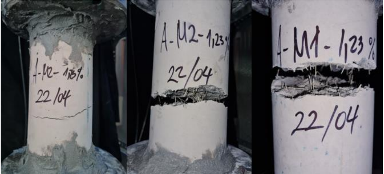
Figura 5-3 Modo de Fallo Ensayo a Tracción
