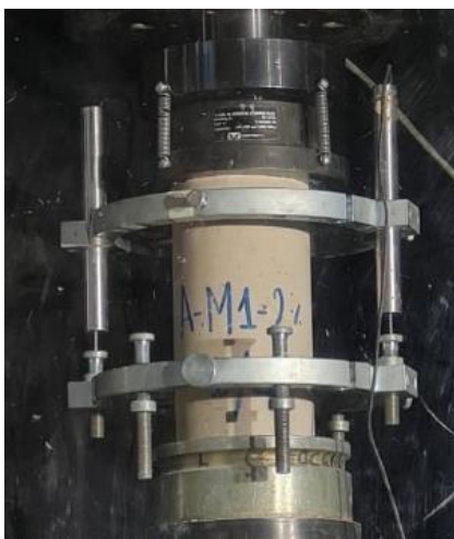
Figura 4-10 Montaje Ensayo Compresión
