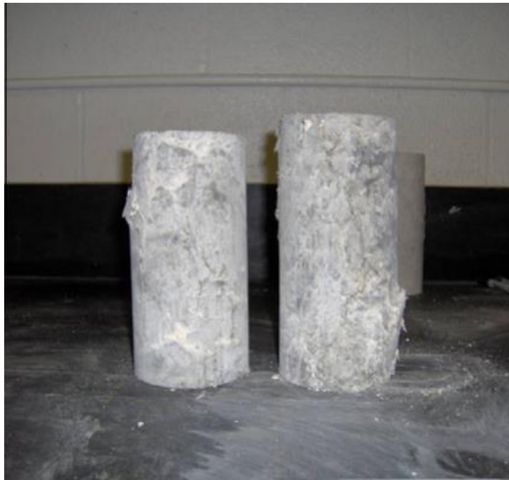
Figura 3-5 Fallo de probetas de microfibras de hormigón. Bajo compresión. Sameer Hamoush, Taher Abu-Lebdeh, Toney Cummins, 2010.
