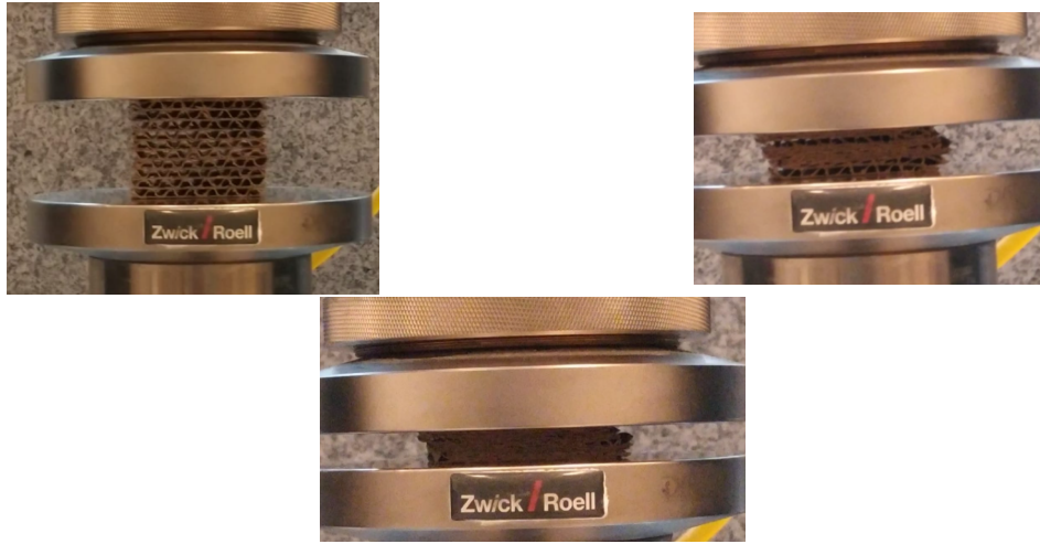
Figura 3.1.16: Secuencia en el colapso de ondas
