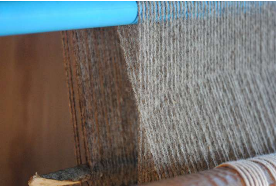
Al observar el telar desde un costado se debe notar el 8 que se forma al instalar el tonón y la barra espaciadora para que se pueda tejer.
