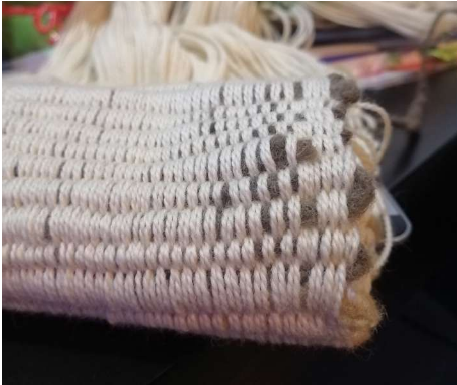
Prueba de retiro de tela sabanilla del telar, para comprobar su flexibilidad y si cumple los requerimientos que se establecen.
