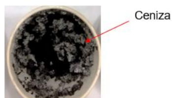
Figura 56. Fotografía de carbón de corcho activado con K 2 CO 3 al 20% a 800°C.
