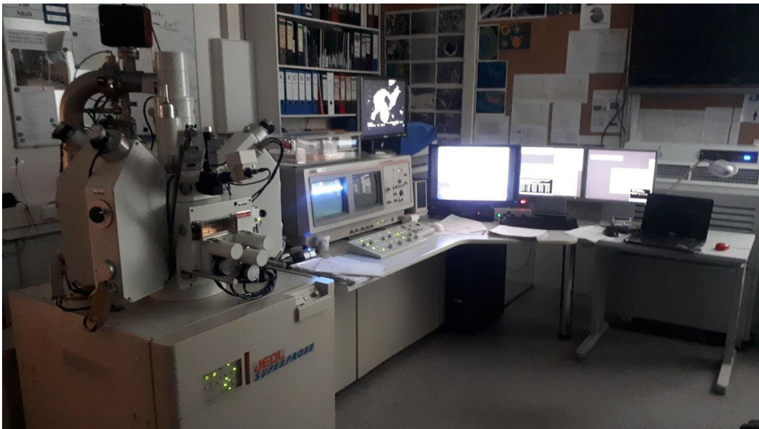
Figura 4.6: Microsonda Electrónica JEOL JXA 890, Centro de Geociencia (GZM), Universidad George-August de Gotinga
