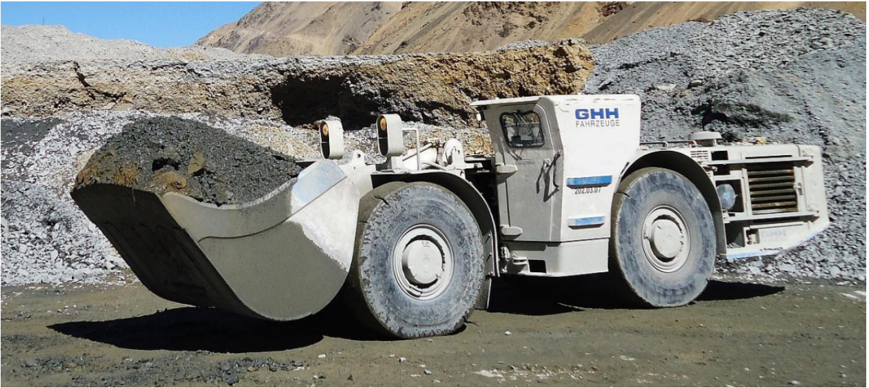
Figura 1.2: Fotografía de LHD modelo LF-11H producido por la empresa alemana GHH [3].
