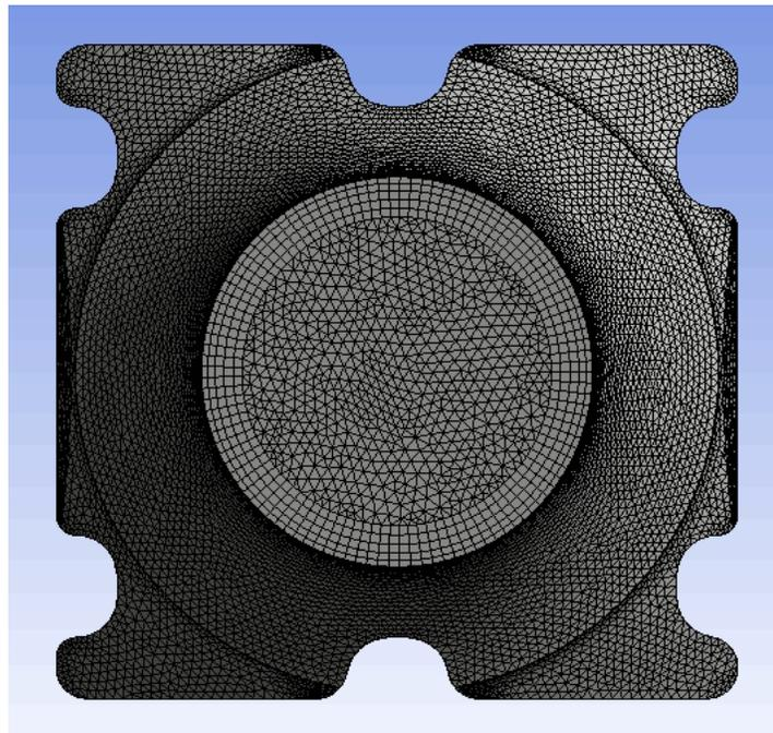
Figura 5.23: Detalle del mallado de la zona final de la Boquilla.
