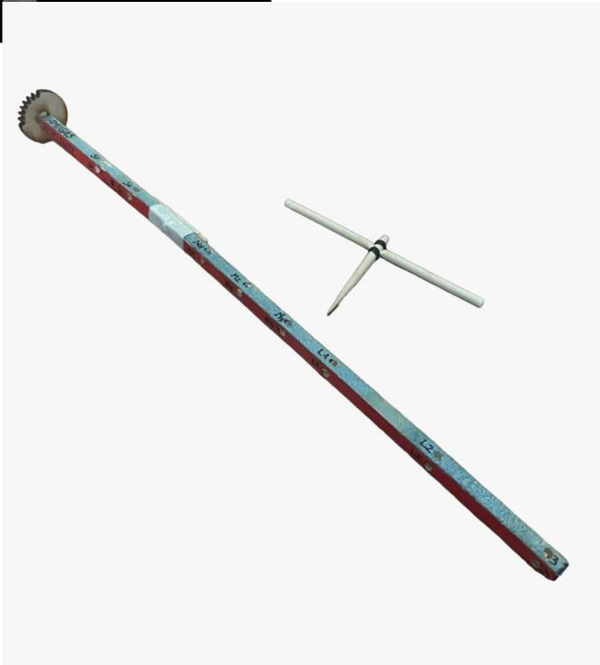
La forma entonces, debe permitir su manejo con las manos, para lo cual se le dio una dimensión aún mayor, al igual que a la rueda, de manera que la tierra no alterare la manipulación del objeto. Además dado que los orificios presentan problemas en cuanto a la debilitación de la estructura, específicamente entre las características del medio, es que se optó por desplazar la rueda y mantener fijo el eje pivote , con el fin de resolver este problema.
