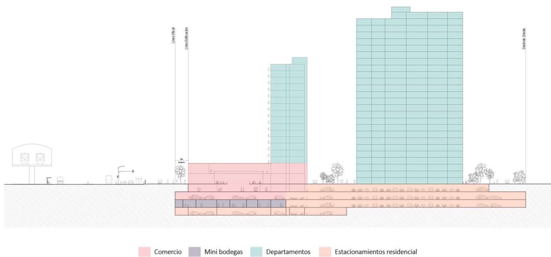
Ilustración 6: Corte longitudinal. Fuente: Elaboración propia.
