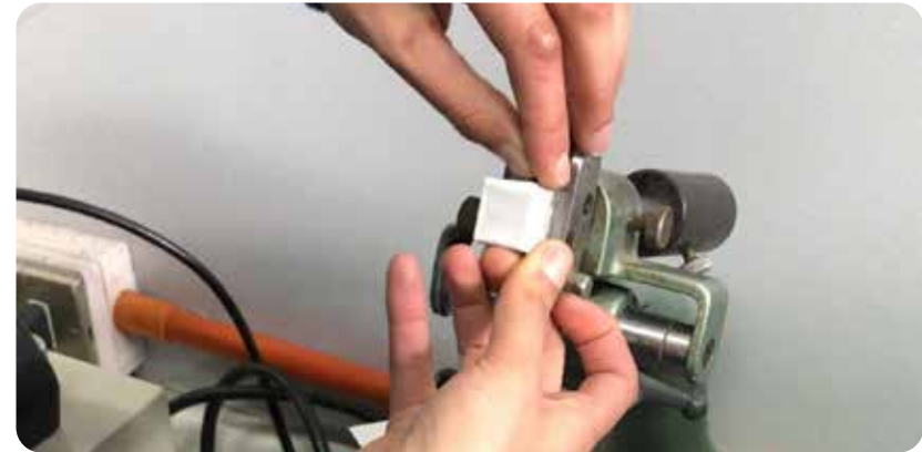
Imagen 84: Instalación del testigo (fieltro).
