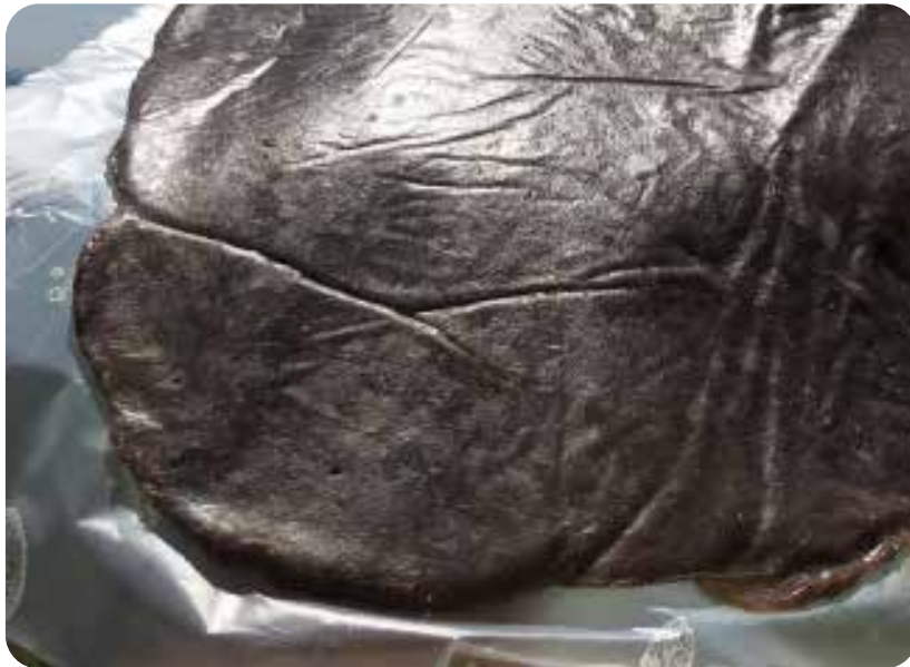
Imagen 149: Surcos formados por contracción de PEAD.
