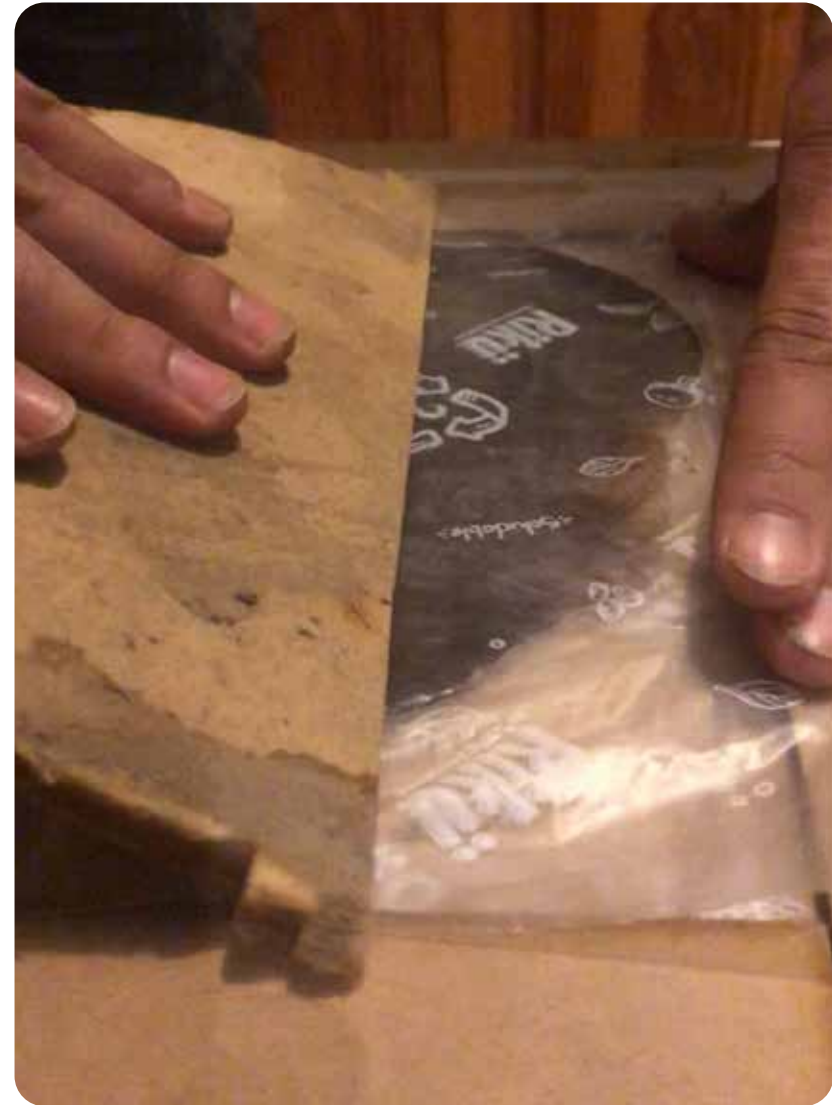
Imagen 108: Extensión de la mezcla entre láminas de PEAD.
