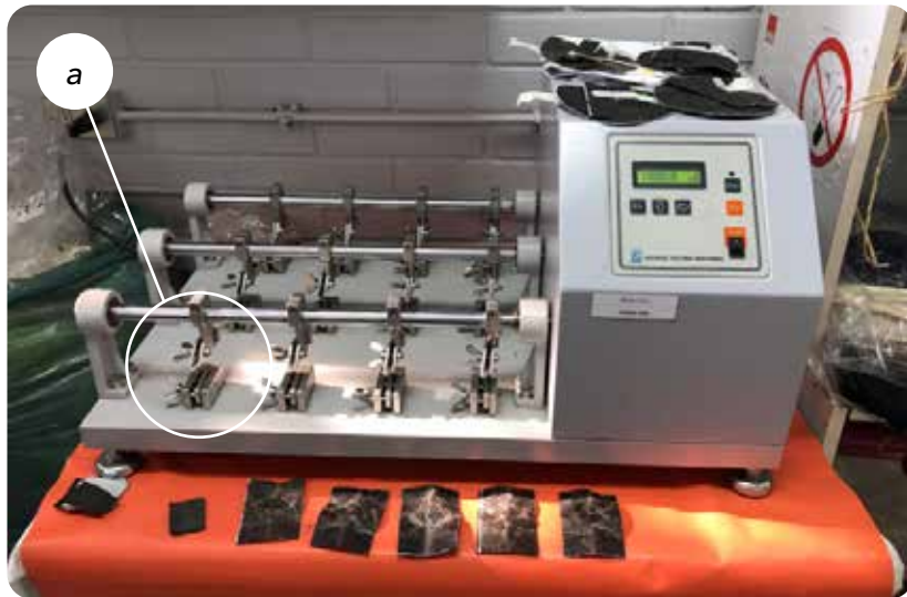
Imagen 80: Aparato para flexión cuero donde se indica (a) sujetador.
