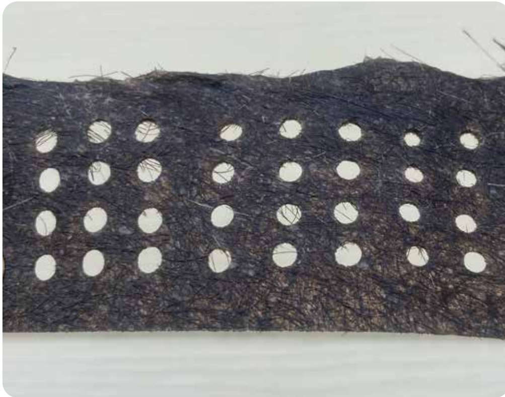
Imagen 183: Perforaciones normales e incompletas
