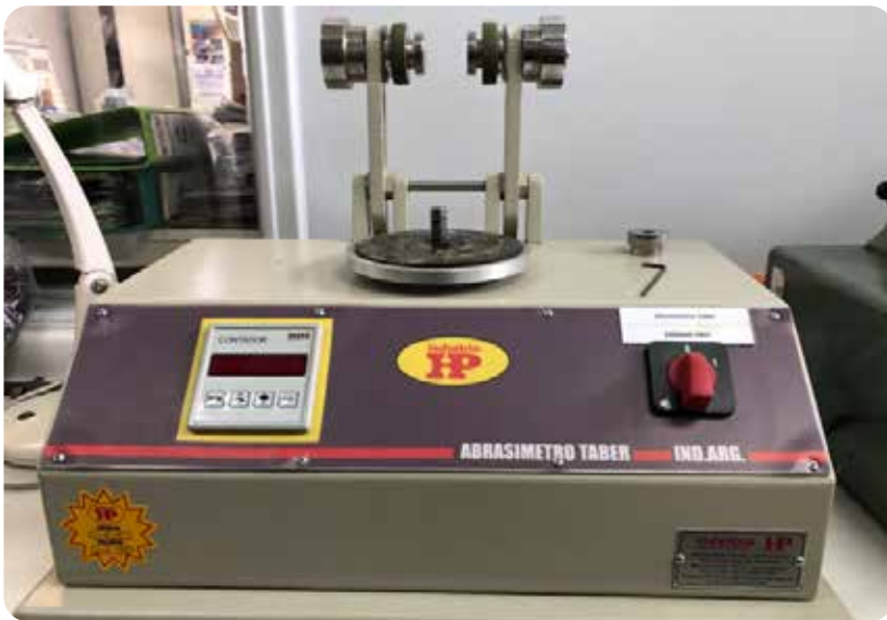
Imagen 86: Abrasímetro Taber, IndustriaHP.
