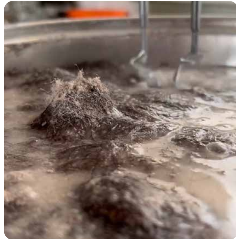
Imagen 122: Aglomeración de pelo pulverizado.
