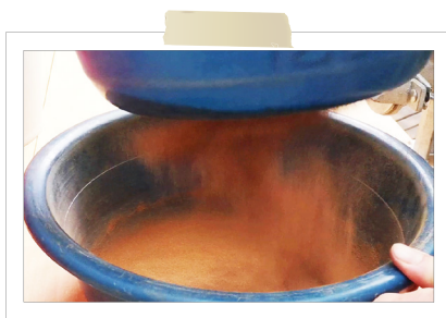
Fig 47: Malla 120. Diámetro de agujero: 0.15 mm / Diámetro de alambre: 0.06 mm . Fuente: Elaboración Propia.
