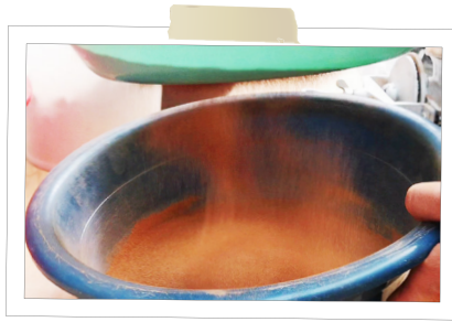
Fig 45: Malla 60. Diámetro de agujero: 0.35 mm / Diámetro de alambre: 0.12 mm . Fuente: Elaboración Propia.
