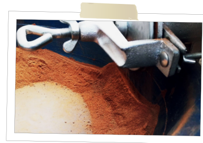
Fig 44: Molienda de la greda en molinillo manual de aluminio de capacidad 500 gr./ Fuente: Elaboración Propia.
