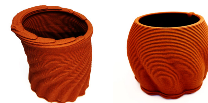
Fig 75: Impresión de cerámica con greda refinada 120 /Fuente: Elaboración Propia.
