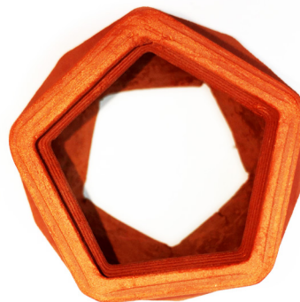
Fig 78: Resultado de impresión con configuración de grosor de capa inferior: 1.0 mm (predeterminado). Escala 100%/ Fuente: Elaboración Propia.
