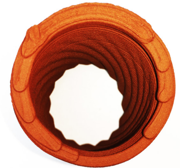
Fig 80: Resultado de impresión con configuración de grosor de capa inferior: 1.0 mm (predeterminado). Escala 100%/ Fuente: Elaboración Propia.
