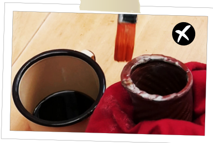
Fig 98: Curado de la pieza cerámica (greda) en frío, con cera natural (pura) de abeja. Generación de grumos de cera, sobre la superficie del material! Fuente: Elaboración Propia.
