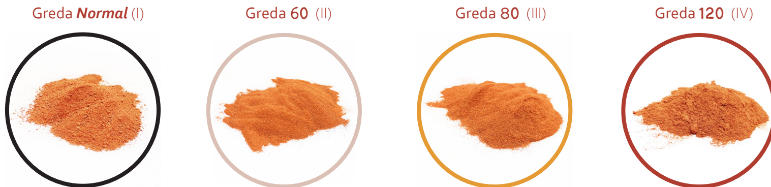
Fig 49: Muestras (500 grs.) de greda normal y refinada por tamizado (60 - 80 - 120)/ Fuente: Elaboración Propia.
