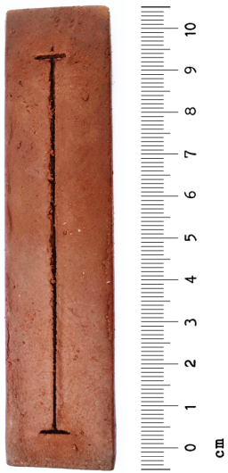
Fig 50: Prueba de secado del material cerámico con el aire (100 mm) Fuente: Elaboración Propia.
