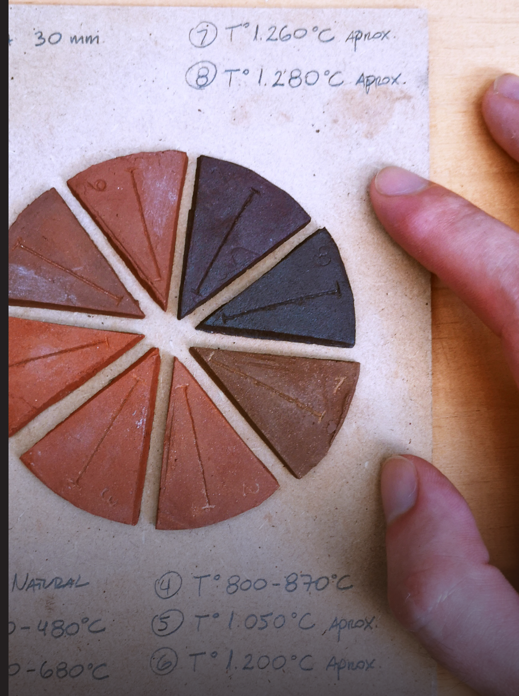
Fig 69: Rueda cromática de arcilla (greda 120) experimental, quemada a diferentes temperaturas para evaluar su nivel de contracción (<30 mm.), cambio de color , grado de vitrificación , entre otras variables de estudio/ Fuente: Elaboración Propia.
