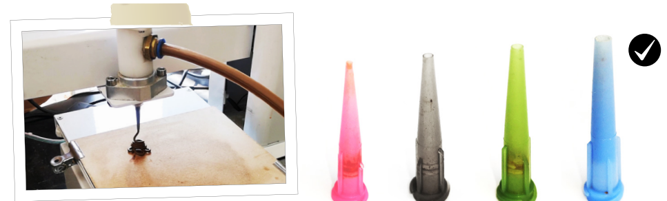
Fig 74: Boquillas. Rosa (0.6 mm). Gris (1.2 mm). Verde (1.6 mm). Azul (2.2 mm) Fuente: eazao.com.
