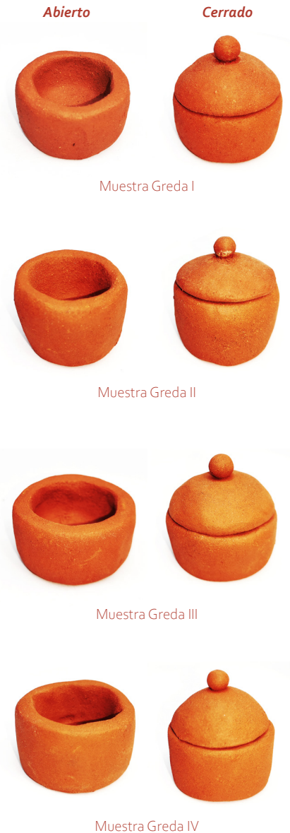
Fig 62: Pruebas de perfumado en las 4 muestras de material cerámico quemado a 800 - 870°C. (C) / Fuente: Elaboración Propia.
