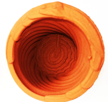
Fig 81: Resultado de impresión con configuración de grosor de capa inferior: 6.0 mm . Escala 82%/ Fuente: Elaboración Propia.
