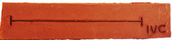
Fig 55: Pruebas de quema a 800 - 870°C (C) de las 4 pruebas de material cerámico. Gredas I, II, III y IV (100 mm)/ Fuente: Elaboración Propia.
