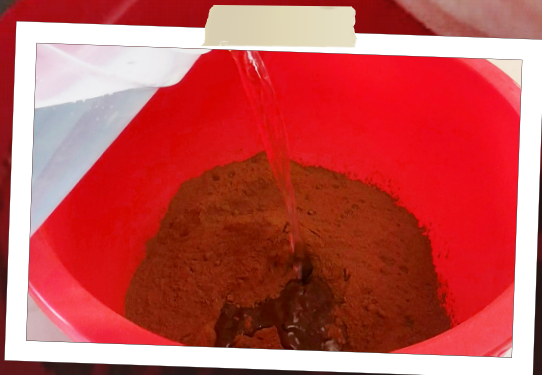
Fig 48: Arcilla de color rojizo con un abundante porcentaje de óxidos en su composición/ Fuente: Elaboración Propia.
