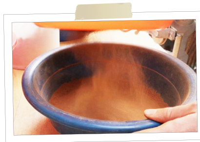
Fig 46: Malla 80. Diámetro de agujero: 0.25 mm / Diámetro de alambre: 0.09 mm . Fuente: Elaboración Propia.
