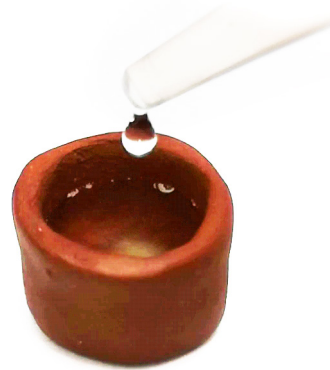
Fig 67: Se agregó agua hirviendo a cada una de las pruebas para comprobar su grado de filtración/ Fuente: Elaboración Propia.
