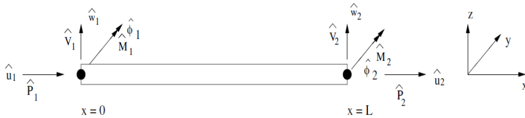
Figura 3.3 Modelo de viga con fuerzas nodales y desplazamientos (Gopalakrishnan y Mitra 2010).
