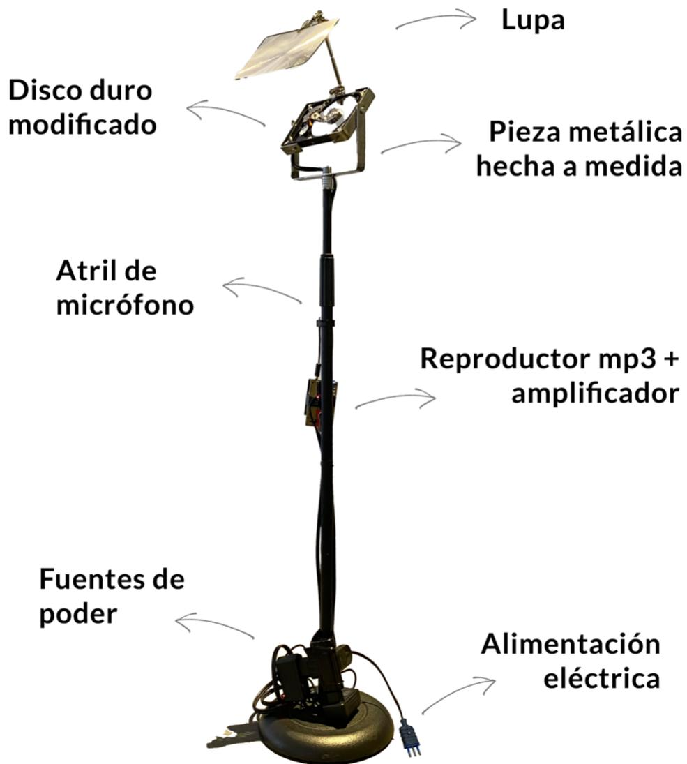
Figura 16: Desglose de elementos de cada ensamblaje. Esquema digital por Matías Serrano. 2023
