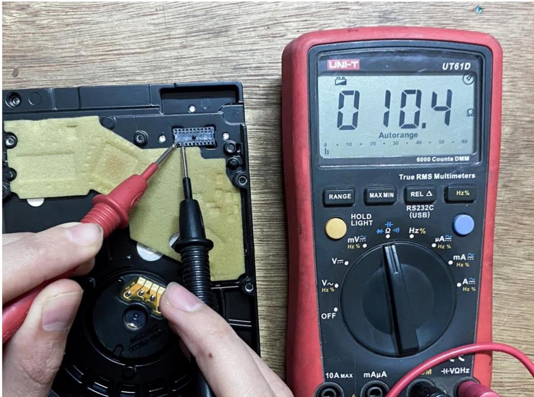
Figura 14: Puntos donde se miden los terminales para encontrar la bobina. En este disco el valor encontrado fue de 10.4 ohms. Fotografía digital por Matías Serrano, 2023.
