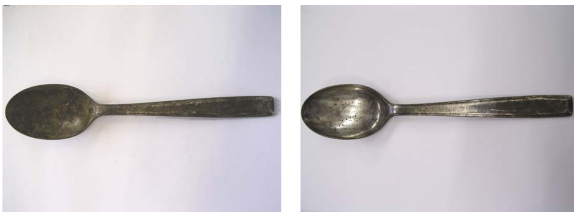
Fig.12: La fotografía de la izquierda muestra la cuchara sin el tratamiento, este objeto está completamente cubierto de sulfuros. En la fotografía de la derecha vemos la cuchara después del tratamiento con Hidróxido de sodio más Ditionita de sodio.
