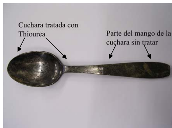
Fig. 13: En la mitad izquierda de la cuchara podemos observar el tratamiento con Thiourea y en la mitad derecha vemos la cuchara sin tratar.
