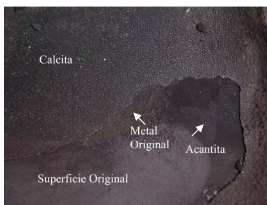
Fig. 26: Diferencia entre calcita, superficie original, metal original y sulfuro de plata.
