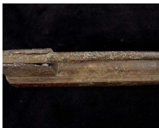
Fig.10: (Izq). Extremo superior del candado antes de la remoción de concreción; presenta pérdida de metal, y el metal que sujeta la varilla, está estabilizado sólo por las concreciones. Como se observa en la otra fotografía (der.) se removió las concreciones, por lo que el metal alrededor de la varilla quedó inestable y con riesgo de rotura. Este sector es el que se estabilizará con Mastic.
