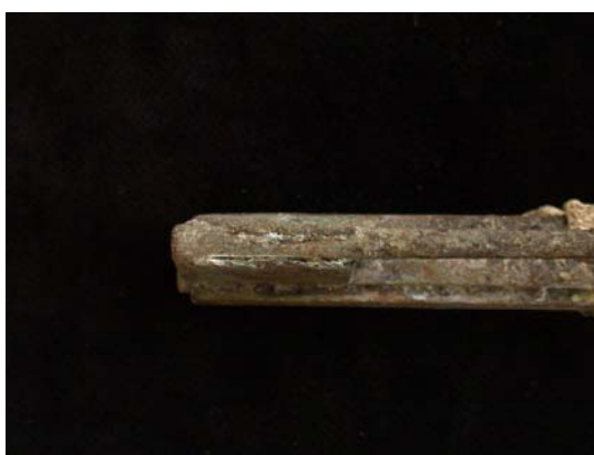
Fig.10: (Izq). Extremo superior del candado antes de la remoción de concreción; presenta pérdida de metal, y el metal que sujeta la varilla, está estabilizado sólo por las concreciones. Como se observa en la otra fotografía (der.) se removió las concreciones, por lo que el metal alrededor de la varilla quedó inestable y con riesgo de rotura. Este sector es el que se estabilizará con Mastic.
