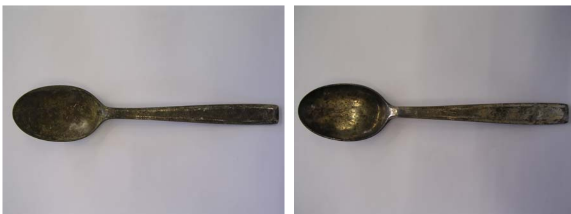
Fig.9: La fotografía de la izquierda muestra la cuchara antes del tratamiento. Aquí podemos observar que el objeto está cubierto completamente por sulfuro de plata. En la fotografía de la derecha vemos la cuchara después del tratamiento por 48 horas con Na_2S_2O_4 .
