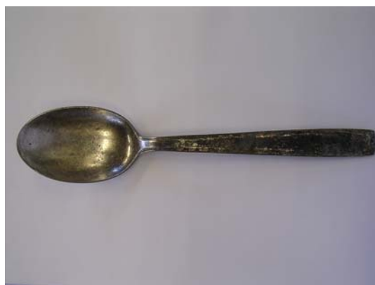
Fig. 10: Cuchara después del tratamiento con ditionita de sodio más carbonatos con etanol
