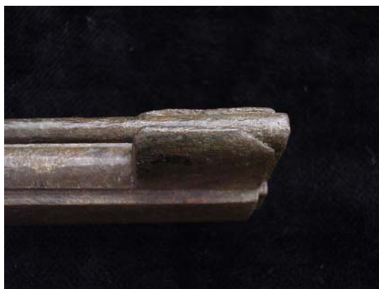
Fig. 11: Consolidación del metal con Mastic y pigmento mineral terminado
