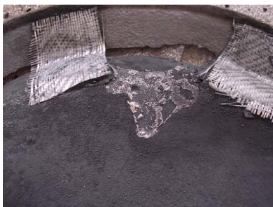
Fig. 28: La figura de arriba muestra los carbonatos que están entre la superficie original y la capa metálica. La fotografía inferior muestra los mismos carbonatos pero ampliados.
