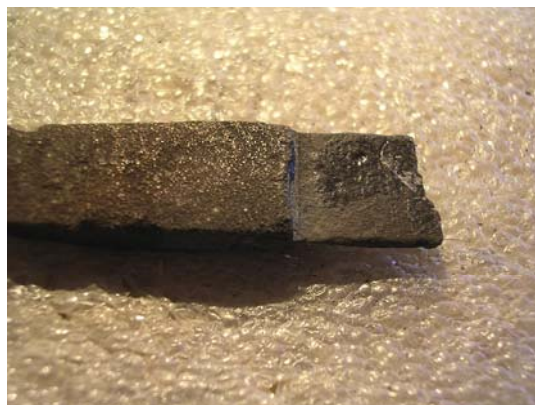
Fig.5: Remoción del pegamento con acetona y tórula. Aquí se observa como el pegamento se ha expandido por la superficie en lugar de solubilizarse. Por lo tanto se sumergirán ambas partes con pegamento en acetona por unos minutos. Nota: Esta fotografía fue tomada bajo la luz raziante del microscopio para una mejor observación del pegamento.
