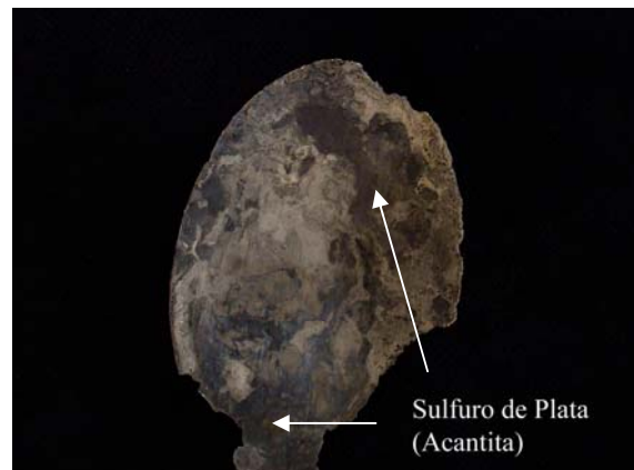
Fig. 4: Aca observamos en la superficie sulfuro de plata de color negro.
