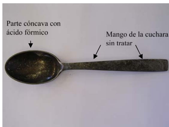
Fig. 11: En esta cuchara se hizo el tratamiento sólo en la parte cóncava con ácido fórmico para así observar mejor la reacción del objeto, y se dejó el mango de la cuchara sin tratar.
