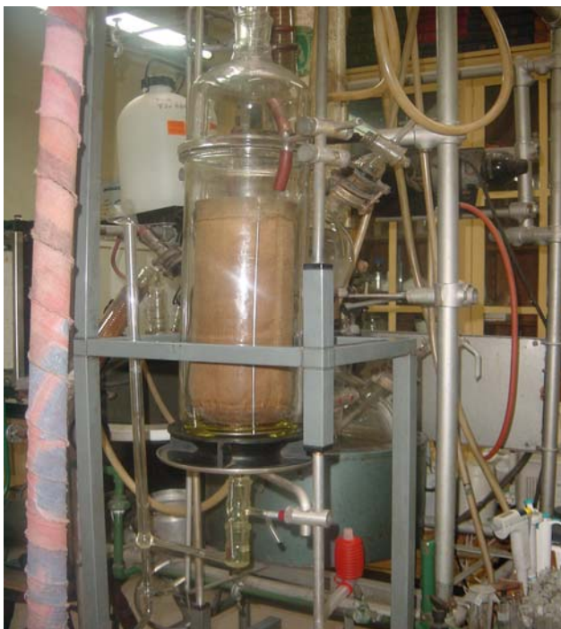
Fig. 4.1.3.2.1: Equipo Soxhlet utilizado para la extracción semi-industrial del aceite de la semilla de quínoa de Paredones.
