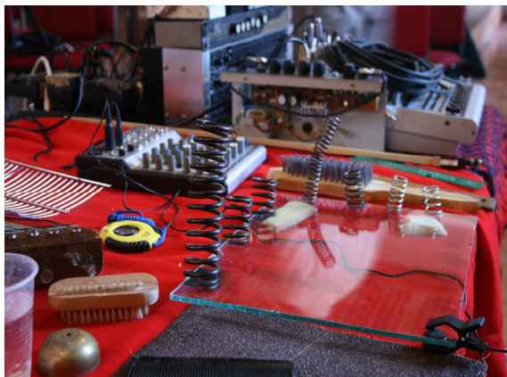
Imagenes 55 y 56 Detalle de la objetos amplificados utilizados por Raúl Díaz; en ambos se puede observar un micrófono de contacto sujeto al vidrio.
