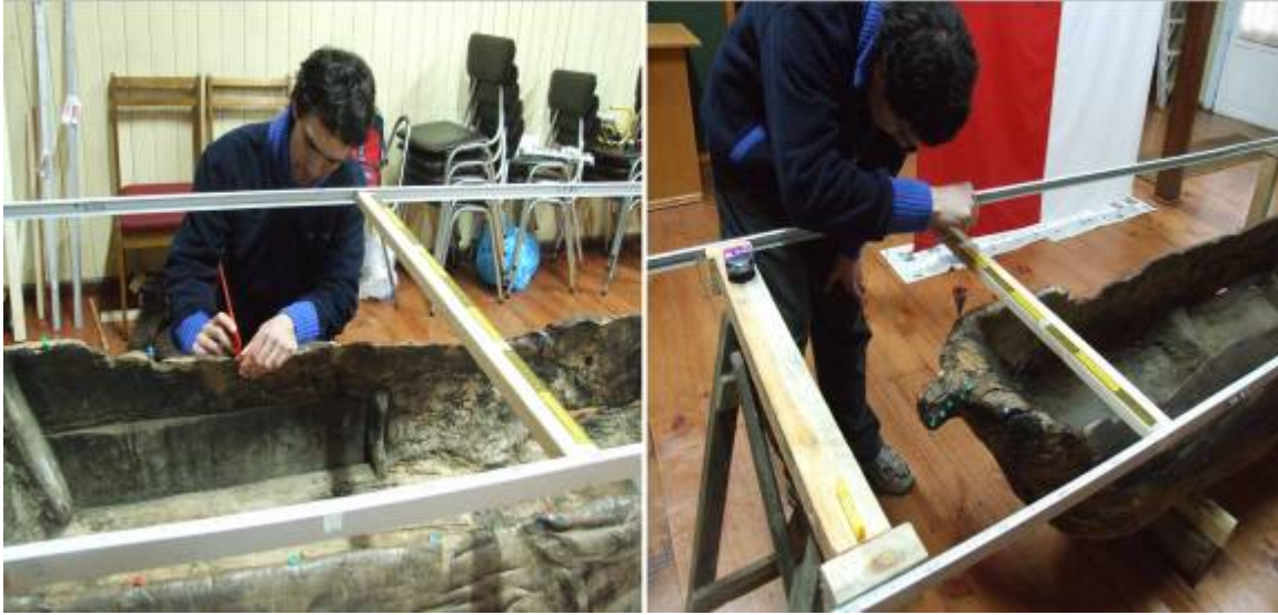
Figura 2. Tareas de levantamiento de la canoa Maule_01. 1.1 Disposición de los puntos a medir. 1.2 Mediciones realizadas con una plomada.
