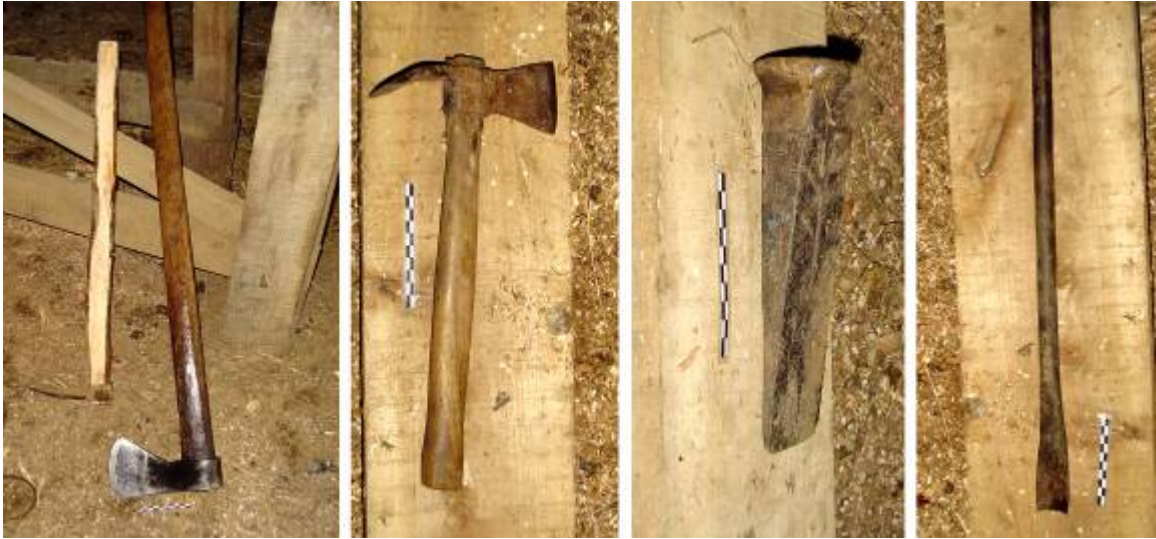
Figura 1. Herramientas utilizadas por Don Ernesto Marifilo para el trabajo en madera. De izquierda a derecha: 1.1 Hacha y azuela, piezas grandes utilizadas en la mayor parte del procedimiento. 1.2 Azuela de mano o maichiwe usada para dar los retoques. 1.3 Cuña metálica que sirve para partir el tronco. 1.4 Gubia que se utiliza para tallar.
