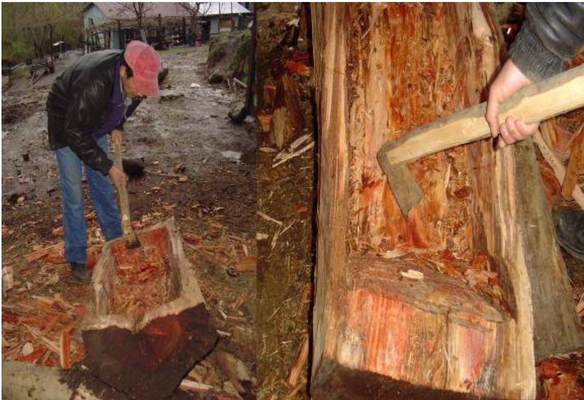
Figura 9. Una vez extraída la mayor parte de la madera se continúa el trabajo de retoque con la azuela, logrando un adelgazamiento de las paredes. Esta se introduce en forma
