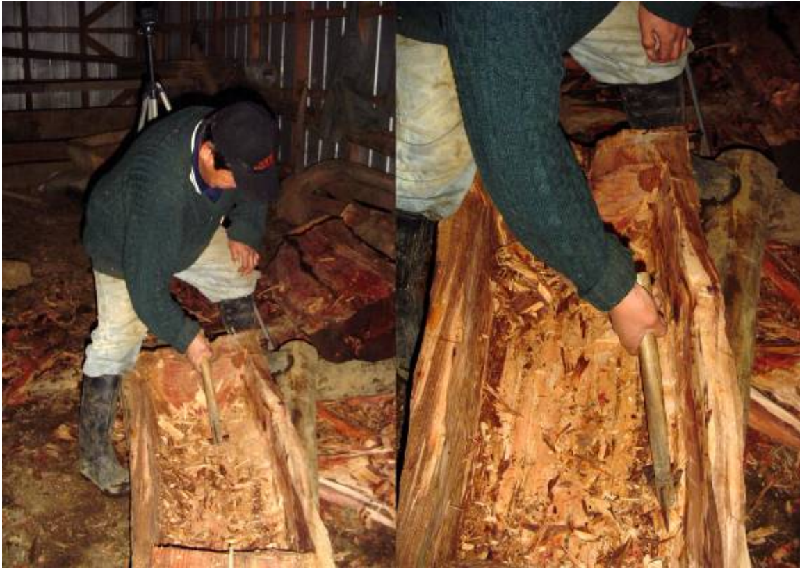
Figura 11. El retoque final se realiza con una azuela de mano, más pequeña, llegando a un adelgazamiento máximo del piso de la batea, y cuidando de no romperlo. En la secuencia se observa de izquierda a derecha: 11.1 Don Ernesto maneja la azuela de mano en los retoques finales; 11.2 detalle del uso de la azuela de mano sobre la batea.
