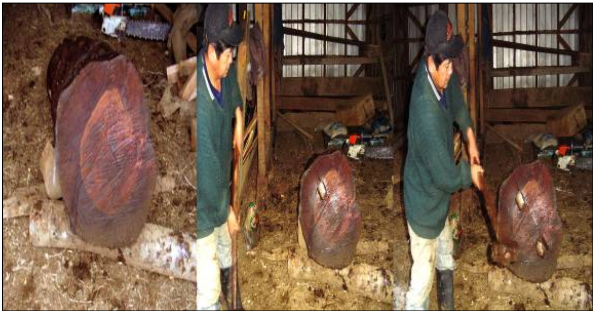
Figura 2. Inicio del procedimiento de construcción de la batea. De izquierda a derecha: 2.1 El tronco se prepara para el trabajo; 2.2 se sitúa una cuña metálica en una grieta o “viento” del tronco donde Don Ernesto golpea con un combo; 2.3 la grieta se expande y se coloca una segunda cuña metálica.
