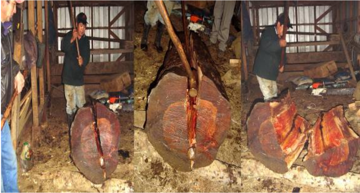
Figura 3. Secuencia de rajadura del tronco. De izquierda a derecha: 3.1 y 3.2 el tronco esta casi partido y solo se requiere introducir el combo en la grieta para que termine de partirse; 3.3 el tronco se ha rajado en dos mitades casi perfectas.
