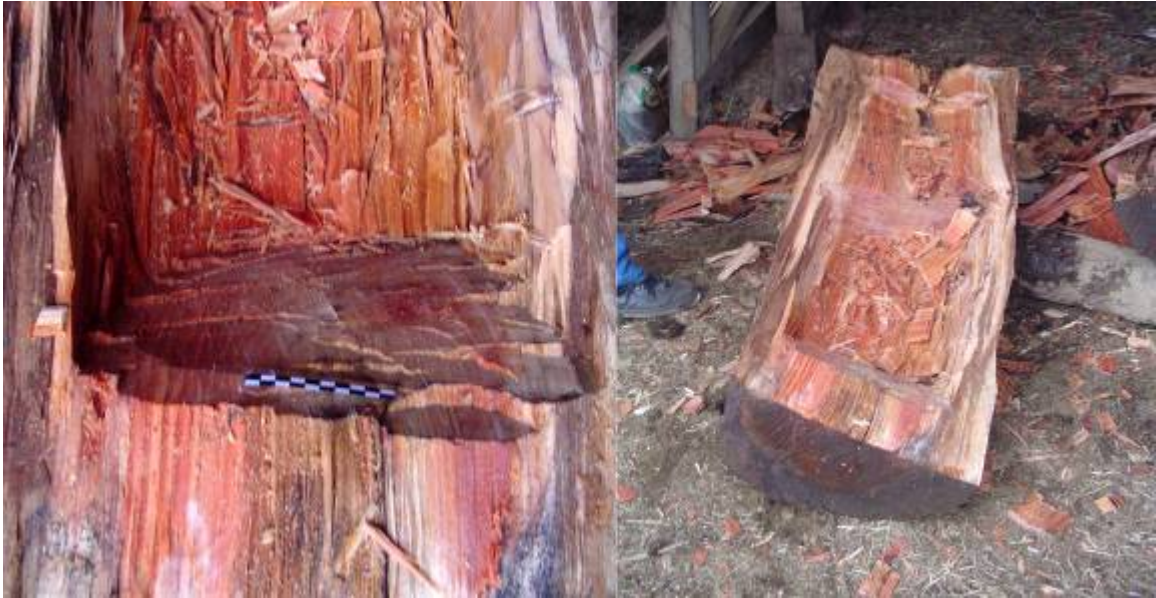
Figura 8. Ahuecamiento del tronco mediante la técnica de cortes transversales. De izquierda a derecha: 8.1 Acercamiento de las huellas que va dejando el hacha sobre la madera en los cortes transversales; 8.2 se aprecia el proceso de ahuecamiento en dos secciones del tronco a partir de los extremos.
