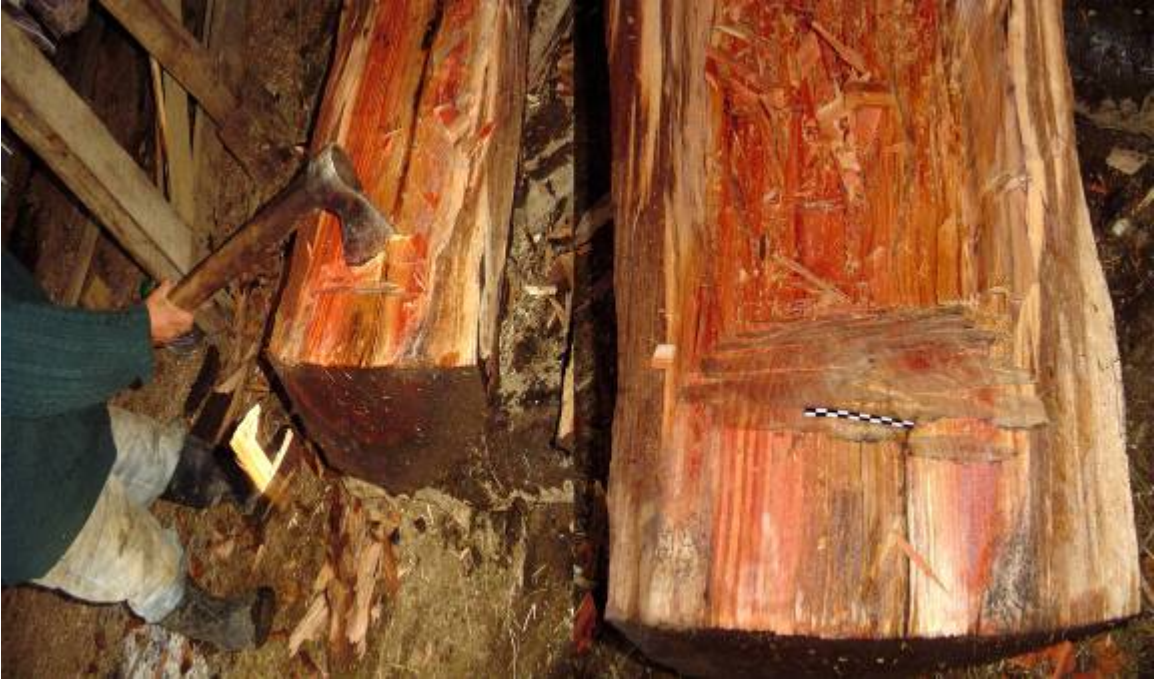
Figura 7. El ahuecamiento del tronco se realiza mediante la técnica de cortes transversales en los extremos y el centro del tronco, para luego extraer longitudinalmente aprovechando las fibras de la madera, la masa que se encuentra entre estos cortes. En la secuencia se aprecia como se va realizando uno de estos cortes transversales con el hacha, y las huellas que van quedando sobre la madera.
