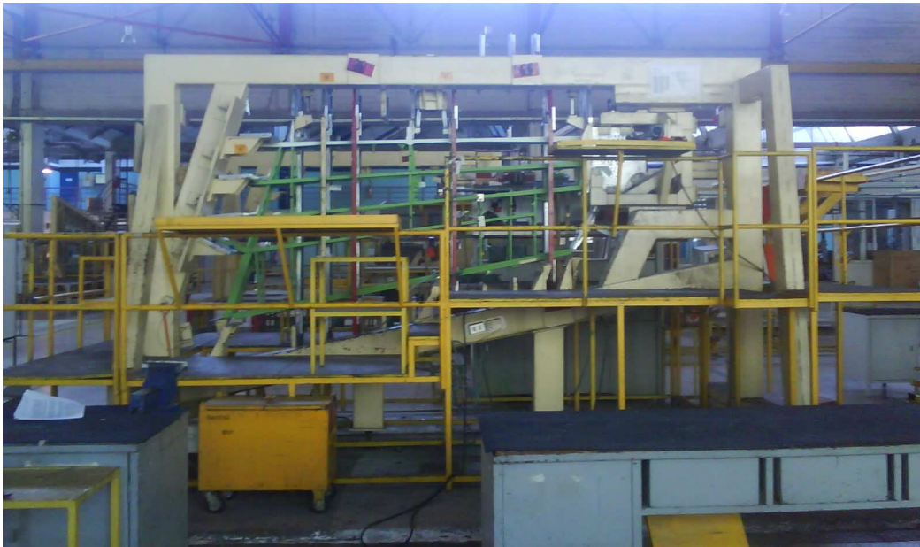
Figura 1 Imagen Grada y puesto de trabajo operarios montaje Estabilizador Vertical avión EMB-145
