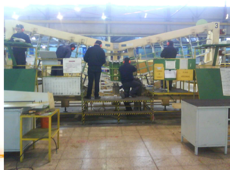
Figura 2 Imagen Grada y Puesto de trabajo montaje Estabilizador Horizontal EMB- 145
