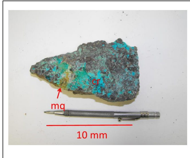
Figura 4.4. Malaquita. La malaquita es un mineral poco frecuente en el yacimiento. La muestra de mano que se muestra en la figura contiene pátinas de crisocola (cr) y una amígdala de cuarzo, atacamita y malaquita (mq), esta última fácilmente diferenciable por sus propiedades físicas. Esta muestra de mano fue sometida a análisis en muestras fraccionadas de difracción de rayos X arrojando valores positivos para la malaquita de la amígdala.
