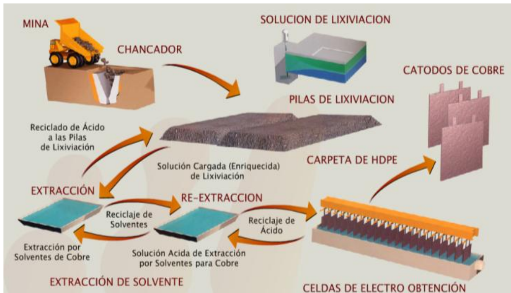
Figura 10: Diagrama de flujo de procesos mina Spence. (Fuente: Compañía minera Spence)
