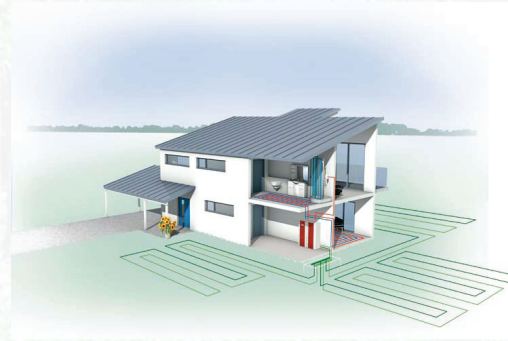
Imágen 22: Sistema Bomba de Calor Tierra-Agua Fuente: Enerficaz
