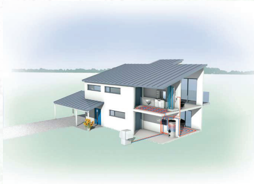
Imágen 21: Sistema Bomba de Calor Aire-Agua Fuente: Enerficaz
